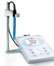
PH700 Kit de medidor de pH de sobremesa
