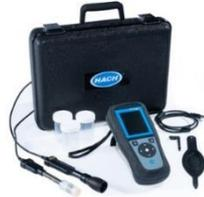
Multímetro portátil HQ4200, con electrodos de pH de gel y
