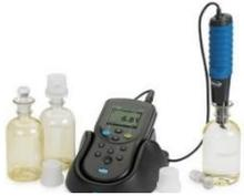
Medidor de oxígeno disuelto para DBO
