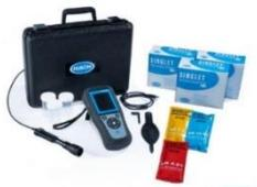
Medidor portátil de oxígeno disuelto HQ1130, con electrodo de oxígeno disuelto
